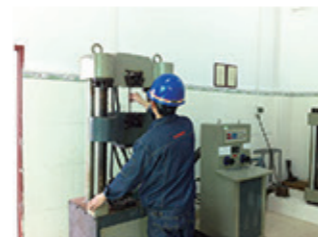
钢筋抗拉试验 Rebar Tensile Test
